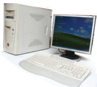
(تصویر ۱) قسمت‌های مختلف کامپیوتر: مانیتور (بالا سمت راست)، کیبورد (پایین سمت راست) و کیس در سمت چپ
